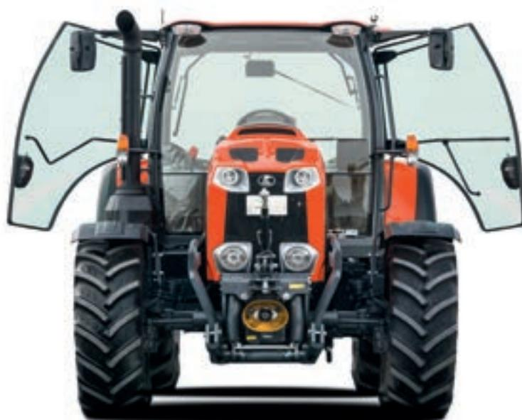
Anche la visibilità notturna è ottima: quattro proiettori anteriori standard e quattro potenti luci di lavoro a LED (opzionali) montati sul tettuccio della cabina trasformano la notte in giorno.
